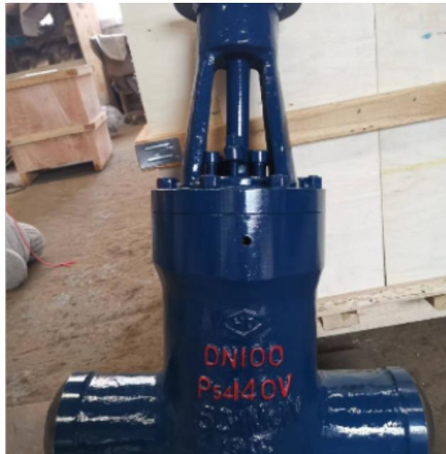
闸阀是粉料、晶粒料、颗粒料及小块物料的流量或输送量的主要控制设备，普遍使用在冶金、矿山、建材、粮食、化工等行业控制流量变化或迅速切断。开启阀门时，当闸板提升高度等于阀门通径的1:1倍时，流体的通道完全畅通，但在运行时，此位置是无法监视的。实际使用时，是以阀杆的顶点作为标志，即开不动的位置，作为它的全开位置。为考虑温度变化出现锁死现象，通常在开到顶点位置上，再倒回1/2-1圈，作为全开阀门的位置。因此，阀门的全开位置，按闸板的位置（即行程）来确定。
