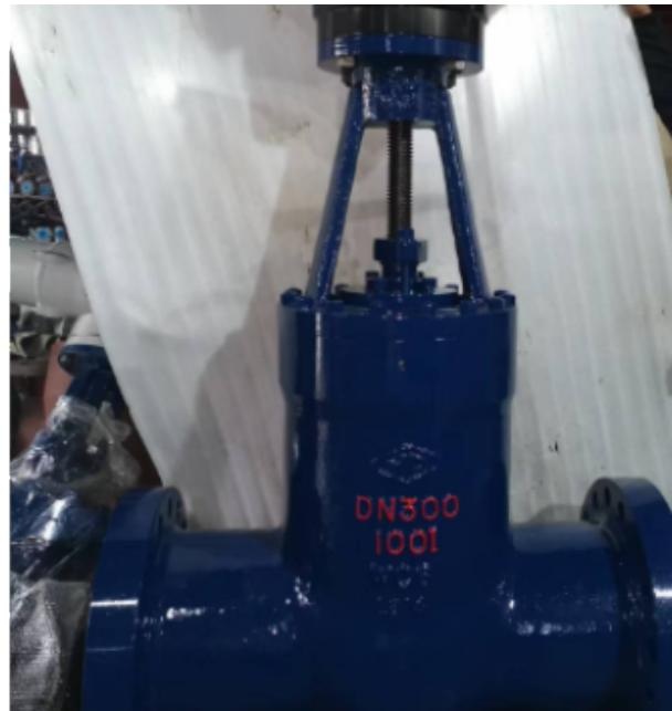
闸阀是截断阀，密封性能不及截止阀。闸阀主要“职责”是“断流”，以及以小的阻力：“续流”。它不宜用作调节介质的流量和压力，如长期用于调节，密封面易被介质冲刷磨损，影响密封性能。闸阀的介质温度、压力，对使用的可靠性应引起注意。在高温、高压时，由于温度的变化可能使闸板卡死，同时因各处介质温度不均匀，易产生不密封现象。楔式闸板阀尤为明显。常见故障分析各类阀门共性常见故障见章，闸阀常见特殊性故障分析如表：故障制造质量的原因用户方面的原因相应用户须知开不启1T型槽断裂（铸件或加工不合格）1T型槽断裂（已超过上死点，仍大力开扭操作）浙江电站闸阀批发闸阀，就选上海精一电站阀门有限公司，让您满意，有想法可以来我司咨询！
