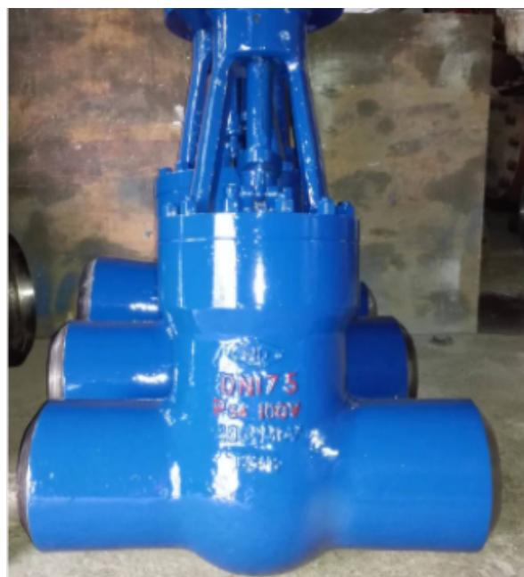
启闭无摩擦。这一功能完全解决了传统阀门因密封面之间相互摩擦而影响密封的问题。上装式结构。对装在管道上的阀门可直接在线检查与维修，能有效减少装置停车，降低成本。单阀座设计。消除了阀门中腔介质因异常升压而影响使用安全的问题。低扭矩设计。特殊结构设计的阀杆，只需配一个小手把阀门就能轻松启闭。
